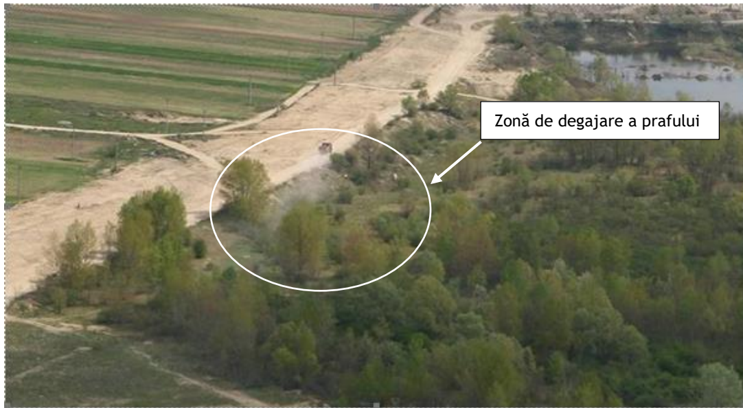
Figura nr. 6-4 Exemplu de degajare a prafului pe un drum de lângă o carieră, ca urmare a traficului auto pe drumurile de exploatare
